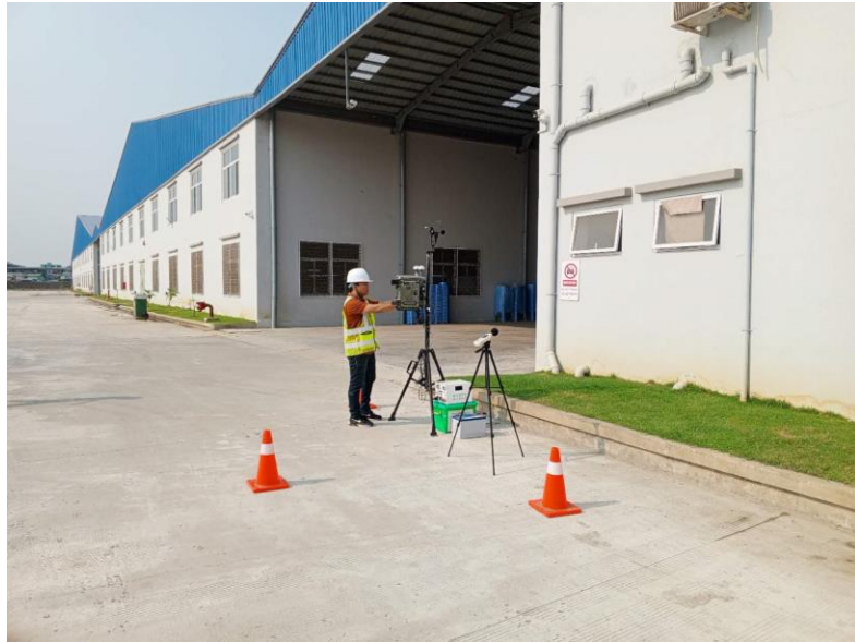
ပုံ (19) HAZ-SCANNER™ Model-EPAS ဖြင့် လေထုအရည်အသွေးတိုင်းတာခြင်း
