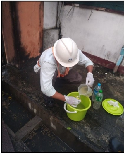
ပုံ (၂၀) စက်ရုံစွန့်ပစ်ရေအရည်အသွေးအား Total Coliform Bacteria ဓာတ်ခွဲစစ်ဆေးရန်အတွက် ပိုးသတ်ထားသော အိတ်ဖြင့် ရေကုန်ကောက်ယူခြင်းနှင့် အပူချိန်တာမူ မှတ်တမ်းဓာတ်ပုံများ
