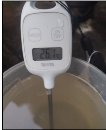
ပုံ (၂၀) စက်ရုံစွန့်ပစ်ရေအရည်အသွေးအား Total Coliform Bacteria ဓာတ်ခွဲစစ်ဆေးရန်အတွက် ပိုးသတ်ထားသော အိတ်ဖြင့် ရေကုန်ကောက်ယူခြင်းနှင့် အပူချိန်တာမူ မှတ်တမ်းဓာတ်ပုံများ
