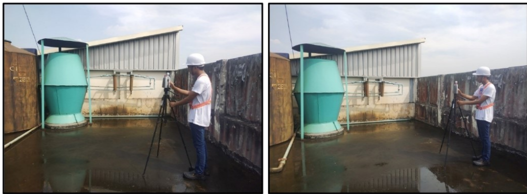
ပုံ (၉) စက်ရုံ၏ အပေါ်ဆုံးအထပ် (၆ လွှာ) ရှိ Air Jet Filter (၂) လုံး၏ နံဘေးတွင် လေအရည်အသွေးတိုင်းတာမှု မှတ်တမ်းဓာတ်ပုံများ
