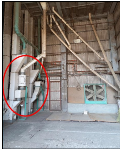
ပုံ (၄.၁၅) Raw Bin အတွင်းမှ ဂျုံစေ့များအား Magnet သံလိုက်ကိရိယာဖြင့် ဂျုံစေ့အတွင်း သံတိုသံစများကို ပထမအကြိမ် ဖယ်ထုတ်ခြင်းပုံ
