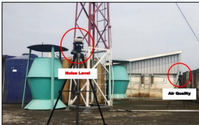
ပုံ (၁၆) စက်ရုံ၏ အပေါ်ဆုံးအထပ် (၆ လွှာ) ရှိ Air Jet Filter (၂) လုံး၏ နံဘေးတွင် လေအရည်အသွေးနှင့် ဆူညံသံအဆင့် တိုင်းတာမှုပြပုံ
