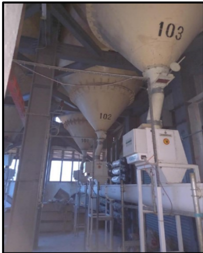
ပုံ (၄.၁၅) Raw Bin အတွင်းမှ ဂျုံစေ့များအား Magnet သံလိုက်ကိရိယာဖြင့် ဂျုံစေ့အတွင်း သံတိုသံစများကို ပထမအကြိမ် ဖယ်ထုတ်ခြင်းပုံ
