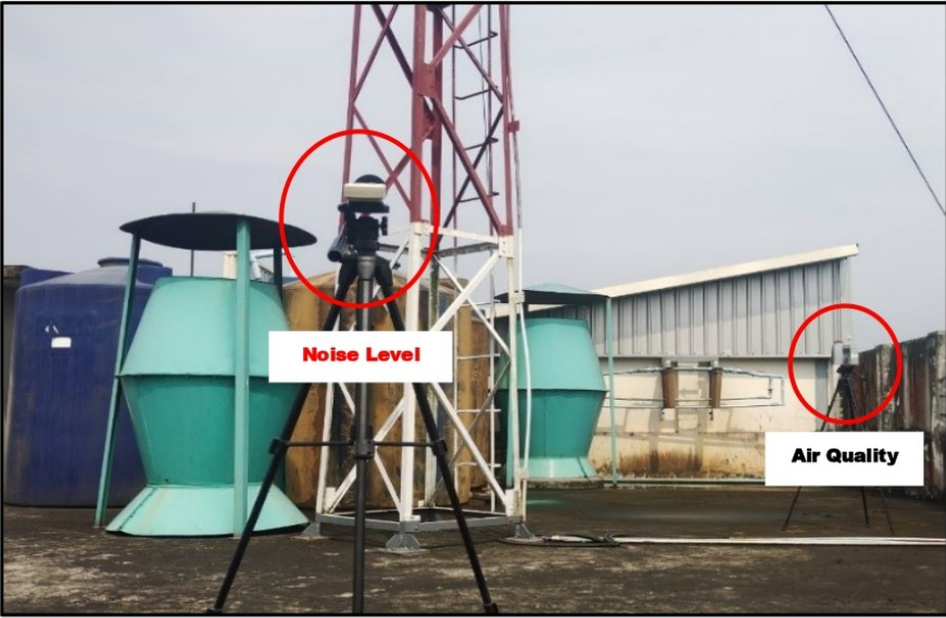
ပုံ (၁၆) စက်ရုံ၏ အပေါ်ဆုံးအထပ် (၆ လွှာ) ရှိ Air Jet Filter (J) လုံး၏ နံဘေးတွင် လေအရည်အသွေးနှင့် ဆူညံသံအဆင့် တိုင်းတာမှုပြပုံ
