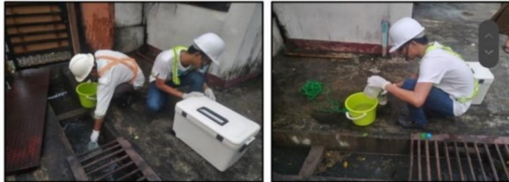
ပုံ (၁၉) စက်ရုံစွန့်ပစ်ရေအရည်အသွေးအား ဓာတ်ခွဲစစ်ဆေးရန်အတွက် ရေနမူနာကောက်ယူမှု မှတ်တမ်းဓာတ်ပုံများ
