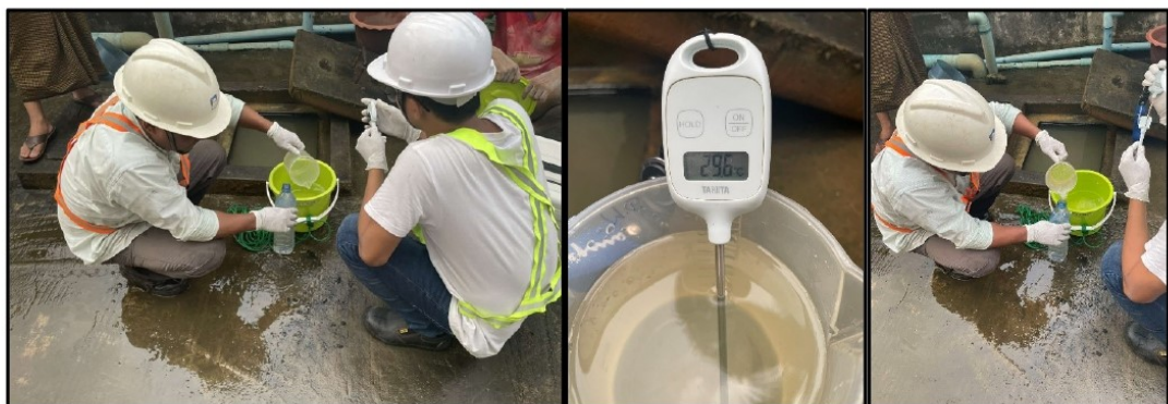
ပုံ (၁၈) မြေအောက်ရေ (အဝီစိတွင်းရေ) အရည်အသွေးအား ဓာတ်ခွဲစစ်ဆေးရန်အတွက် ရေမူနာ ကောက်ယူခဲ့သည့် မှတ်တမ်းဓာတ်ပုံ
