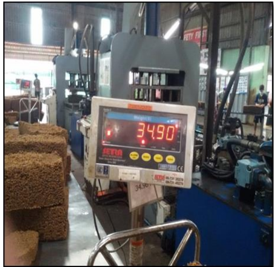
ပုံ(၄-၃၁) ဥစ္စာကိရိယာရရှိရန် Weighing Scale တွင်ညှိနေပုံ
