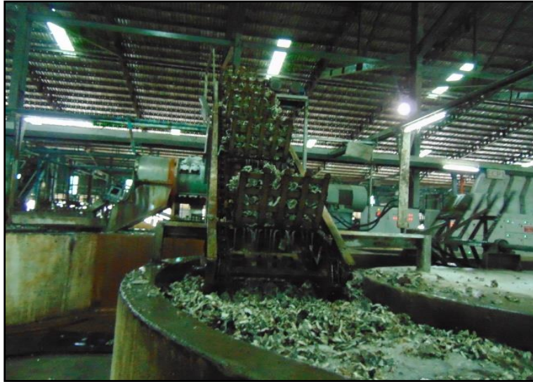
ပုံ(၄-၂၂) Blending Tankတွင်ကုန်ကြမ်းအမျိုးအစားအမျိုးမျိုးတို့ကိုရောနှောနေပုံ
