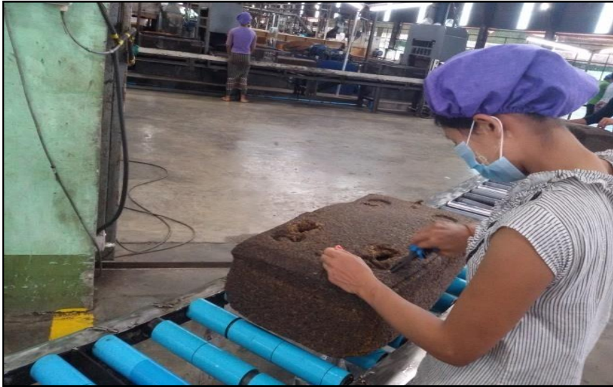
ပုံ (၄-၁၃-၁၈) Inspection Conveyor ပေါ်တွင် ဓာတ်ခွဲစမ်းသပ်ရန် TSR နမူနာယူနေပုံ
