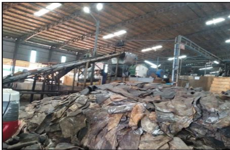
ပုံ(၄-၂၀) Slab Cutter တွင်ခုတ်ဖြတ်ဆုတ်ဖြဲနေပုံ
