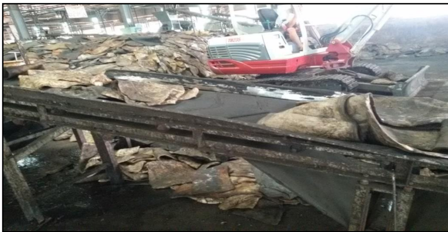
ပုံ(၄-၁၃-၁) ရေပြင်ညီပို့ဆောင်ပေးသော Conveyor Belt ပုံ
