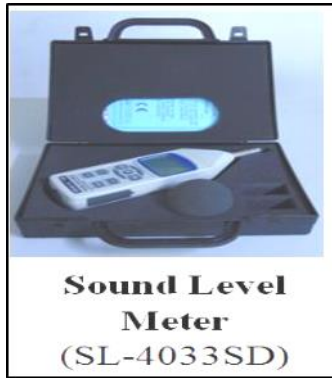
ပုံ(၅-၂၀)။ အသံဆူညံမှုတိုင်းတာရာတွင်အသုံးပြုသောကိရိယာပုံ
