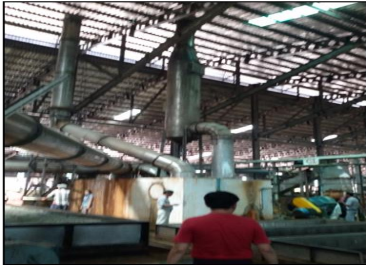
ပုံ(၆-၆) Dryer မှ Air Scrubber သို့ အရိုးအငွေ့များ ပို့ လွှတ်သောပိုက်လိုင်းပုံ
