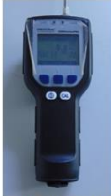
2020 ComboPRO TVOC meter
