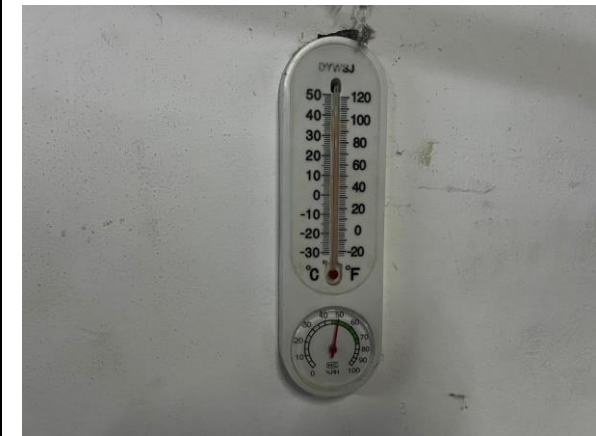
အပူချိန် နှင့် စိုထိုင်းဆတိုင်းကိရိယာထားရှိမှု
