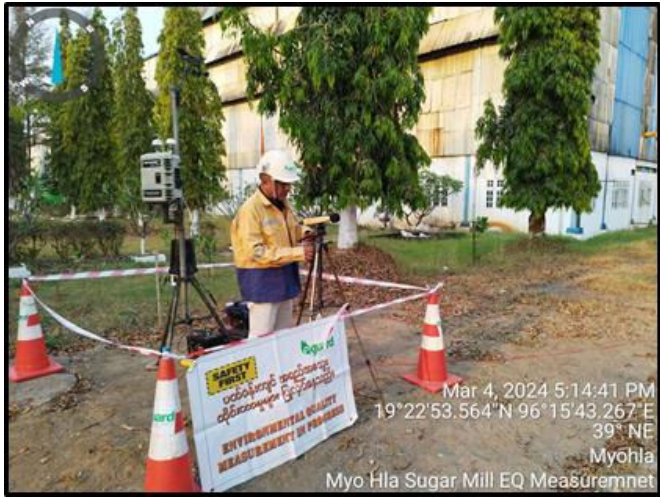
ပုံ ၅.၁ - လုပ်ငန်း ဧရိယာအတွင်းတွင် လေအရည်အသွေး၊ ဆူညံသံပမာဏနှင့် တုန်ခါမှုပမာဏ တိုင်းတာခြင်း
