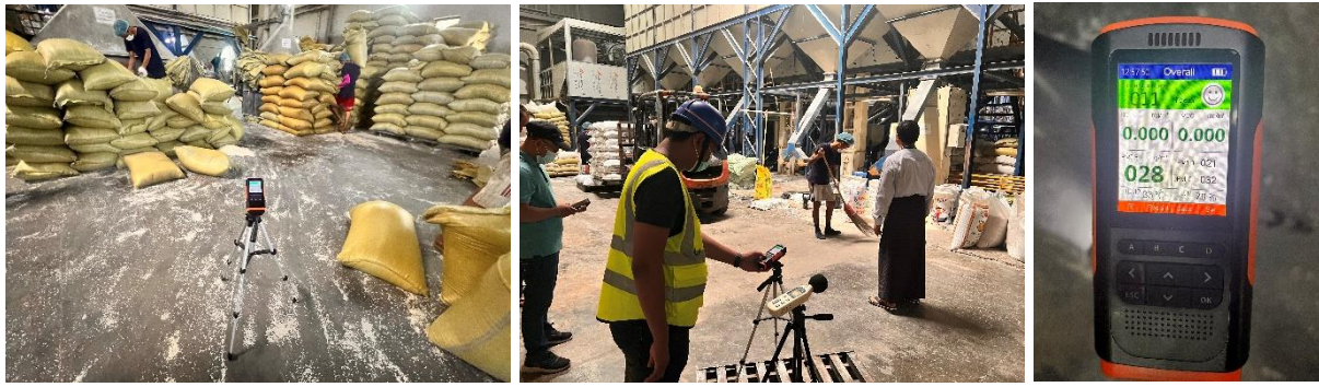
ပုံ 5-20 Air Quality Detector ဖြင့်တိုင်းတာခြင်း မှတ်တမ်းခါတ်ပုံ
