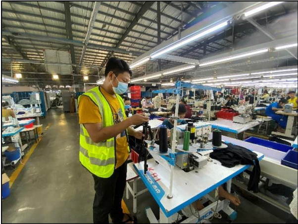
ပုံ ၅-၁၉ စက်ချုပ်လိုင်းအနီးနှင့် မီးပူတိုက်သည့်နေရာများတွင် အလင်းရောင်ရရှိမှုတိုင်းတာစစ်ဆေးခြင်း မှတ်တမ်းဓာတ်ပုံများ
