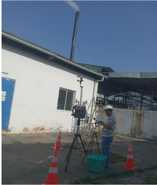
ပုံ (၅.၈) ထိတွေ့ဝန်းကျင်ရှိ ဆူညံသံတိုင်းတာနေပုံ
