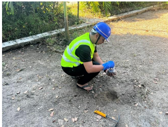
ပုံ ၆-၁၃ မြေနမူနာရယူခြင်း မှတ်တမ်းဓာတ်ပုံ
