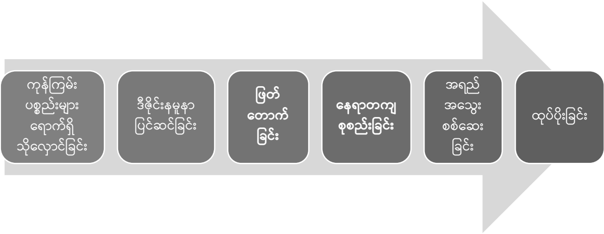
ပုံ ၅-၁၂ ကုန်ကြမ်းမှ ကုန်ချောဆောင်ရွက်ပုံအဆင့်ဆင့်
