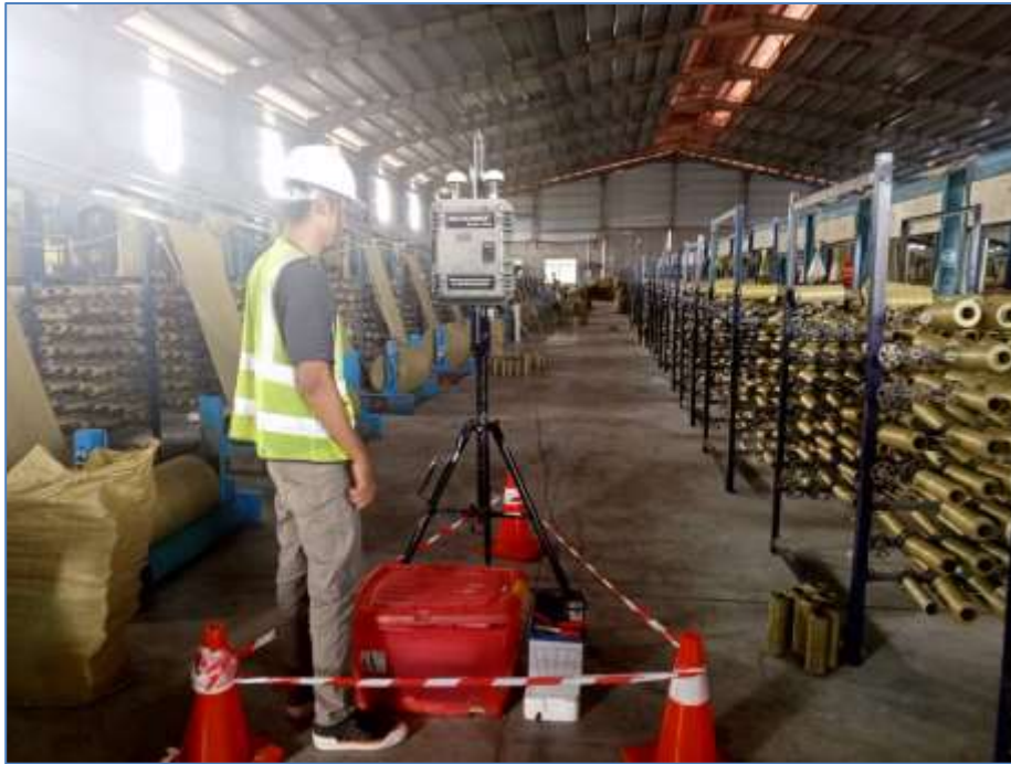
ပုံ 5-7 လုပ်ငန်းခွင်လေအရည်အသွေးတိုင်းတာနေပုံ
