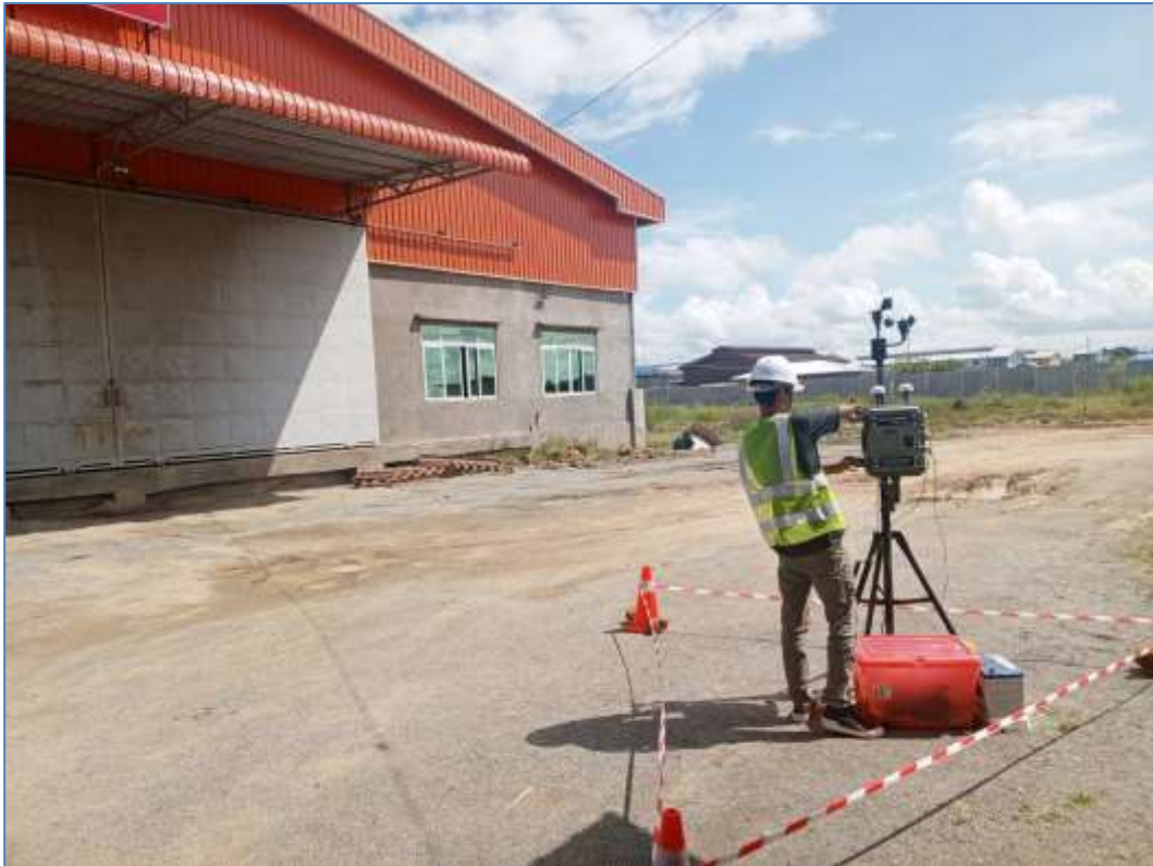
ပုံ 5-6 ပတ်ဝန်းကျင်လေထုအရည်အသွေးတိုင်းတာနေသည့်ပုံ
